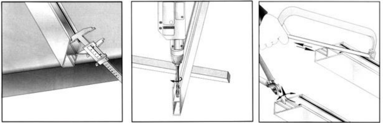
Рис.12. Выполнение пазов в направляющих шинах для запорных элементов.
