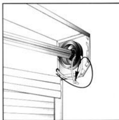
Рис. 20. Закрепление корда на шкиве.
